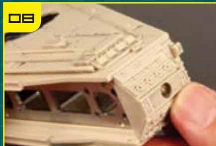
Вклейте четыре штифта фрагмента SP-22 в соответствующие отверстия в раме SF-10, плотно прижав деталь к конструкции.
