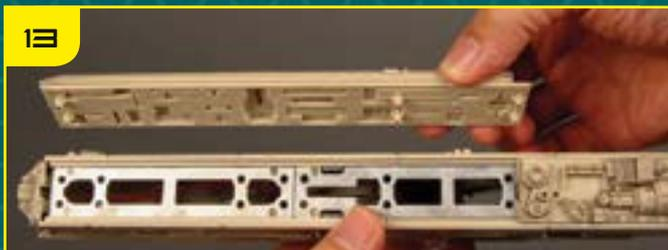
Вклейте шесть штифов фрагмента SP-23 в соответствующие отверстия в каркасе.
