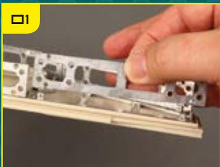
Установите раму SF-09 так, чтобы опорные пластины нижней части «жвала» оказались внутри.
